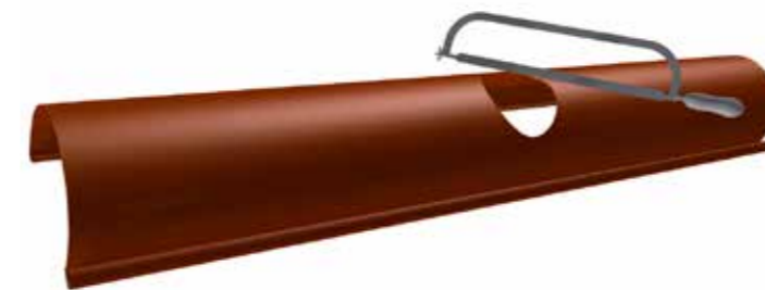
рекомендуемый монтаж сливной воронки
